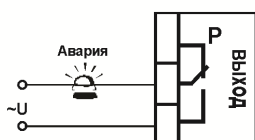
Подключение аварийной сигнализации
