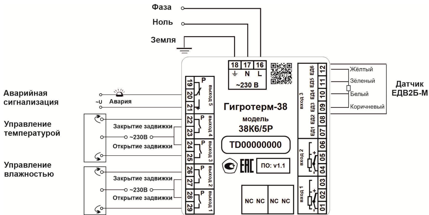
Схема 3. Регулирование влажности и температуры с использованием электроздвижек. Для измерения влажности и температуры применяется датчик ЕДВ2Б-М
