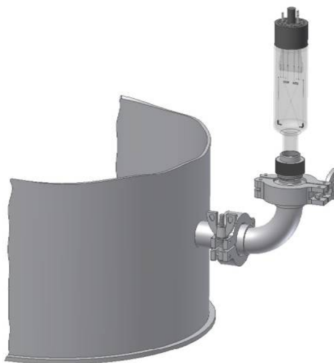
Схема подключения датчика ПМТ-2 к вакуумной системе
