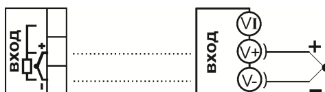
Рисунок 6 – Схема подключения термоэлектрического преобразователя
