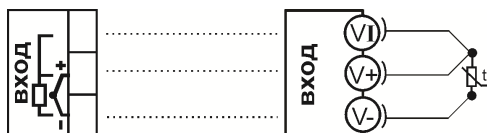
Рисунок 7 – Схема подключения термометра сопротивления
